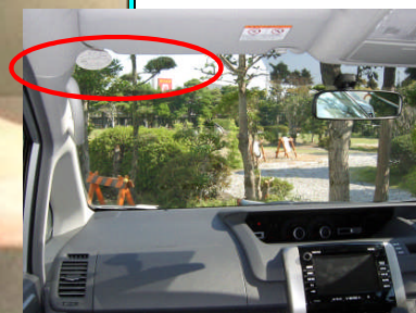
CDMAアンテナ 取付場所
